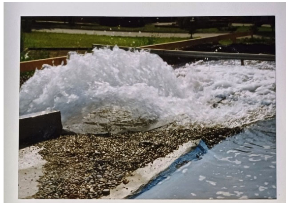
Ф-15 Изглед на отфрлениот млаз од отскочниот праг на слапиштето за проток Q=2420 \text{ m}^3/\text{s}
